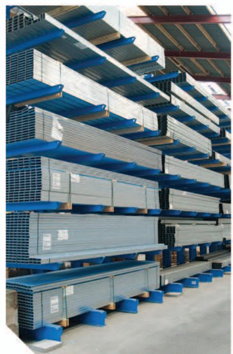
Produsele sunt depozitate in pozitie orizontala pe brate, manual sau folosind stivuitoare sau macarale. Stativele se dimensioneaza conform cerintelor fiecarui beneficiar, iar depozitarea se poate face pe o singura latura sau pe ambele laturi ale raftului. Fara a necesita coloane in partea din fata, sistemul cantilever este mai rapid de incarcat si descarcat decat stelejele standard pentru paleti. Se potriveste foarte bine si pentru placi de material si bunuri voluminoase.
