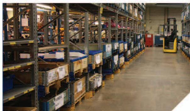
Unitatile Pull-out sunt disponibile in varianta montata pe podea sau in cea montata pe grinda. Toate unitatile sunt livrate cu rulmenti cu bile pentru o manevrare facila. Unitatile pull-out pot fi livrate conform cu tipul de bunuri, raportul greutate/volum, pozitionarea in raft, pentru a obtine o eficienta logistica optima, care include un nivel de lucru adevarat pentru muncitor.
